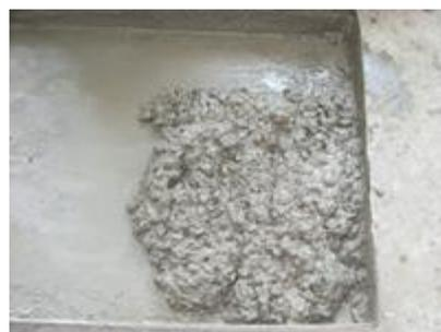
图 1 掺 POZZUTEC 20 初始状态
